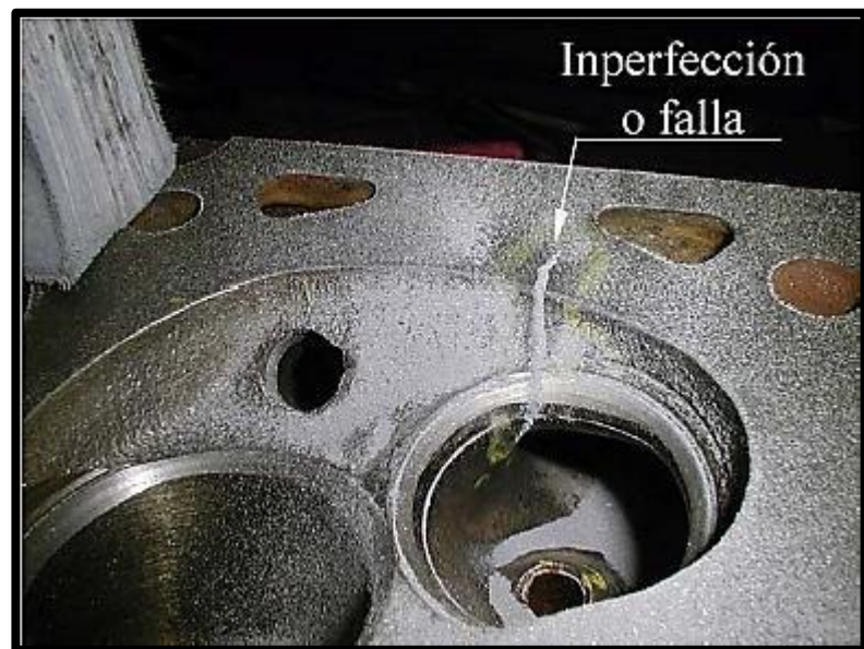
Figura N°77: Detección de falla en culata por intermedio de partículas magnéticas
