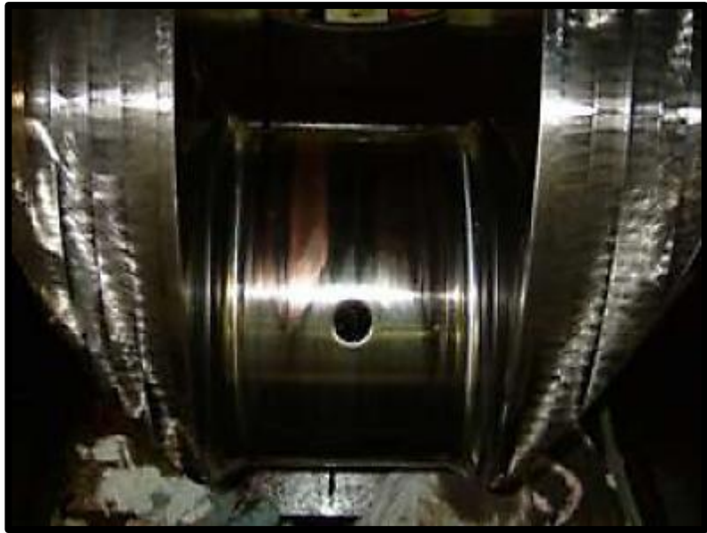
Figura N°82: Muñón de bancada con daños por sobrecalentamiento
