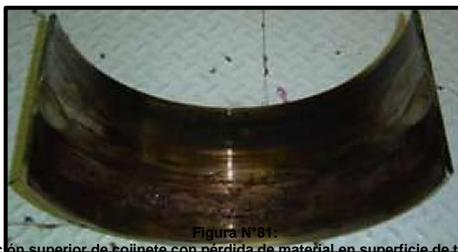
Figura N°81: Sección superior de cojinete con pérdida de material en superficie de trabajo
