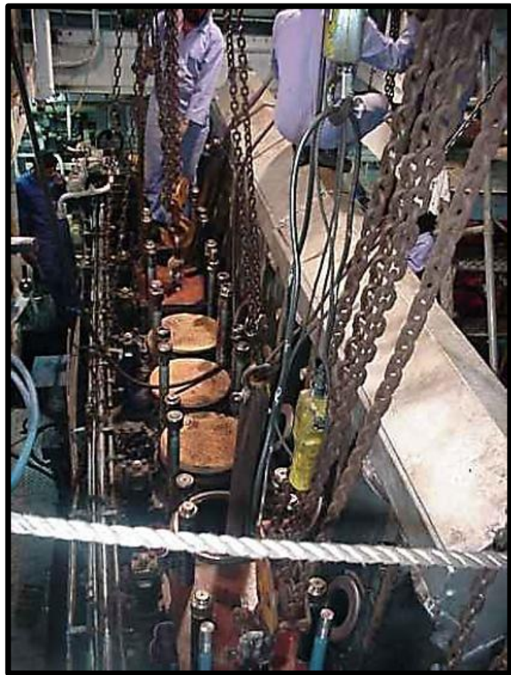
Figura N°89: Desmontaje de Block con cadenas en bloque
