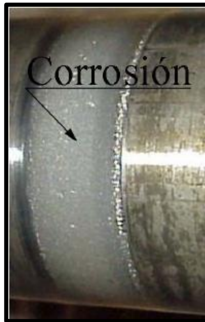
Figura N°63: Corrosión en muñón de cigüeñal
