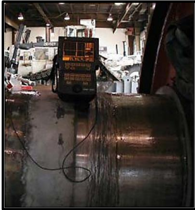
Figura N°79: Instalación de Aparato Transductor
