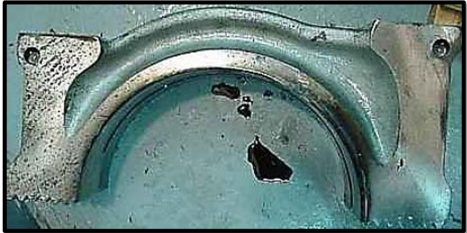
Figura N°88: Desgaste producido entre biela y contrapesos
