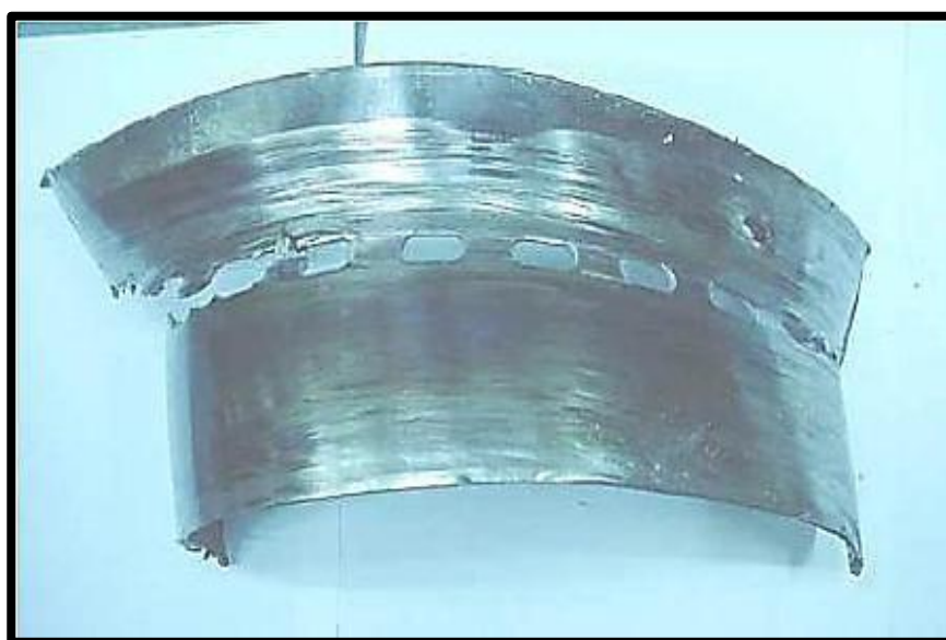
Figura N°85: Daños en sección de cojinete superior
