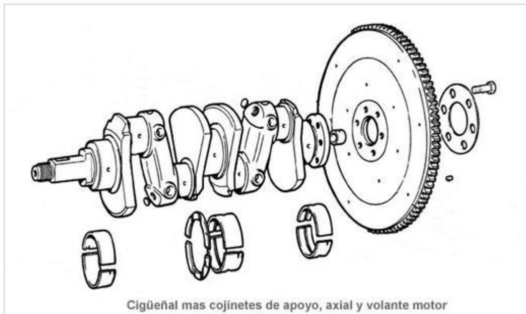
Se deberá rebajar (rectificar) lo menos posible para que la superficie de apoyo del cojinete no disminuya demasiado, pues a medida que se reduce, aumenta la presión unitaria y, por ello, no debe sobrepasarse una disminución de 1 mm al rectificar. También los cigüeñales se deforman longitudinalmente debido a los esfuerzos de torsión que experimentan. Por todo ello es necesaria una comparación las muñequillas y apoyos, así como un equilibrado del mismo.
