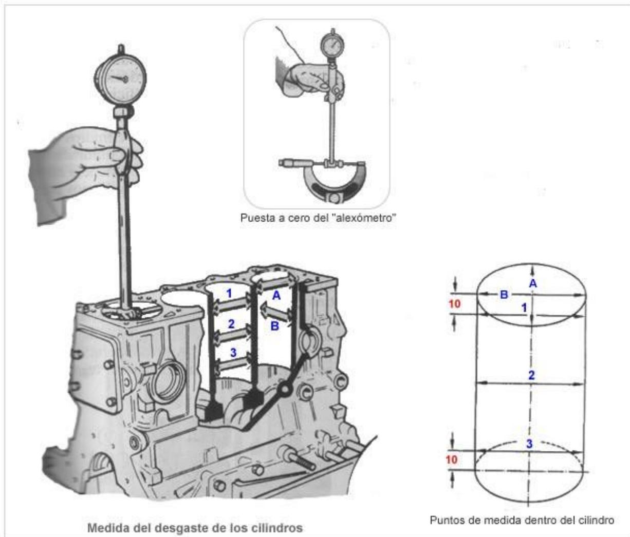
El fabricante puede admitir hasta cuatro rectificaciones a 0,2 mm cada rectificación así como juegos de pistones y segmentos mayorados a las nuevas medidas de rectificación. Generalmente los fabricantes disponen de pistones mayorados en 0,1, 0,2, 0,4, y 0,8 mm, con respecto al diámetro original o estándar. En la siguiente tabla se puede verse un ejemplo de correspondencia entre pistones y cilindros.
