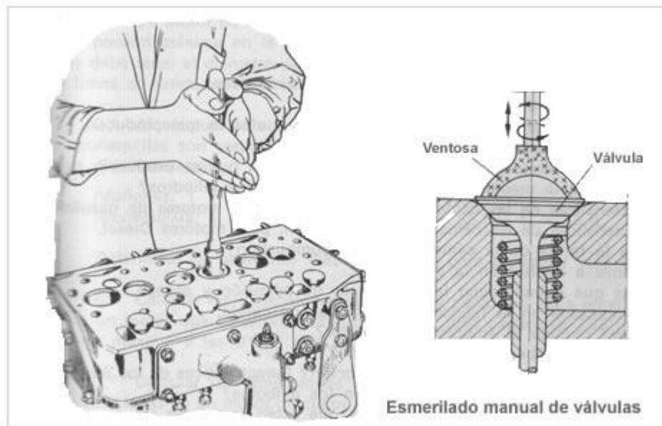
Para comprobar que las superficies quedan con un acabado suficientemente afinado, basta con marcar unos trazos de lápiz sobre el asiento y frotar contra el la válvula en seco. Si los trazos desaparecen, la operación ha sido realizada correctamente.
